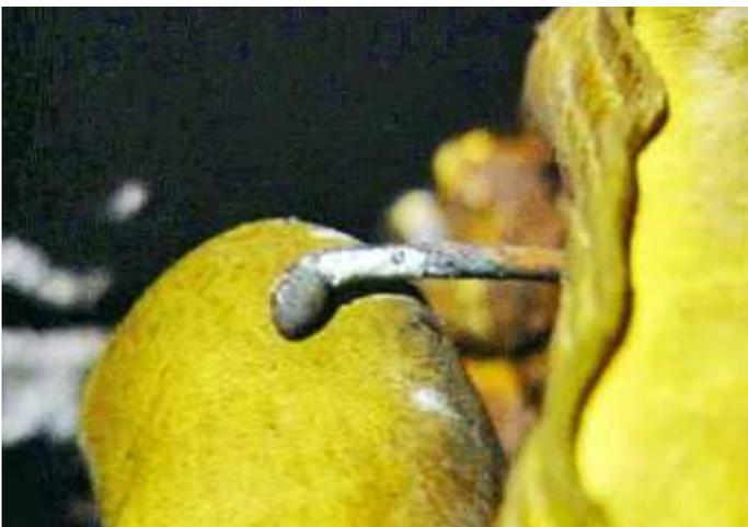
Figura 36.51. Un cortocircuito produce una protuberancia redondeada debida a la fusión del metal conductor.
