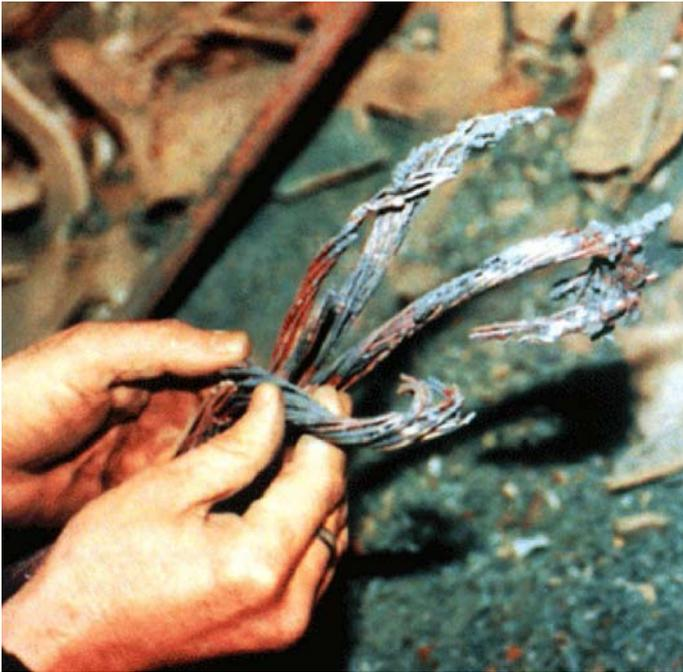
Figura 36.50. Un cortocircuito puede ser el origen de un incendio, pero también el deterioro de los cables debido al incendio puede ser lo que cause un cortocircuito.
