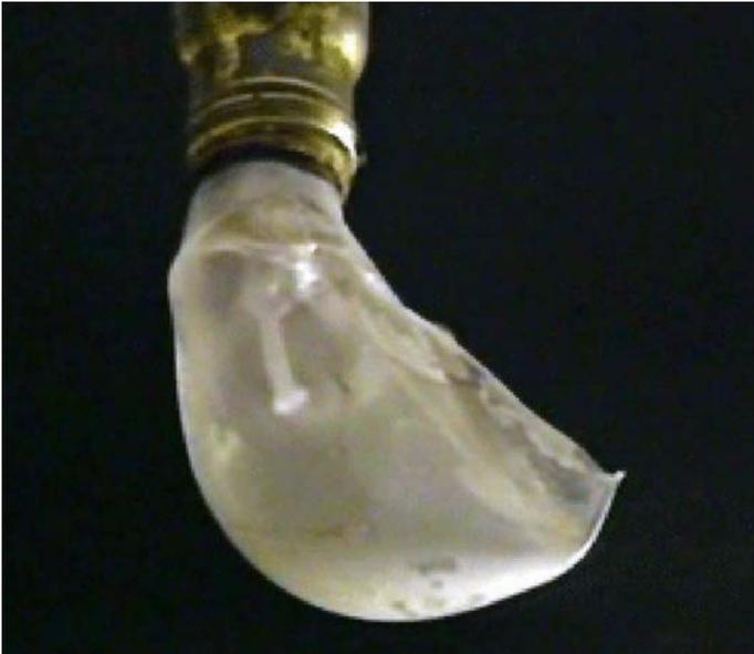
Figura 36.38. Bombilla con el cristal fundido por un incendio. La parte más deformada indica de donde venía el calor.
