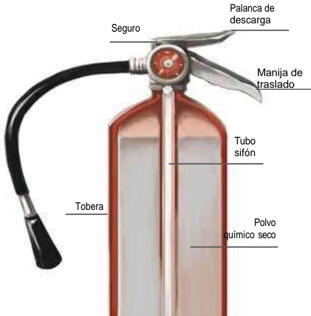
En el sistema de presión no permanente o presión ambiente, el polvo químico seco se guarda en el recipiente a presión a atmosférica (el recipiente debe permanecer cerrado y estanco para evitar el ingreso de aire húmedo que puede apelmazar el polvo e inutilizarlo). El polvo químico seco permanece así hasta que el sistema es accionado y presurizado a la presión del gas impulsor almacenado junto con él.
