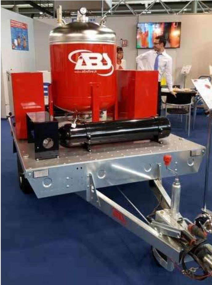
En la imagen se puede apreciar un sistema de almacenamiento de polvo (tanque rojo) y los correspondientes cilindros de nitrógeno para su impulsión (tanques negros) montado sobre un tráiler. Este conjunto puede llevarse al lugar del incendio para ser conectado a una manguera o conjunto de mangueras para la aplicación manual del agente extintor o bien puede trasladarse para ser acoplado a un sistema de tuberías fijas y conducir al agente a un monitor.
