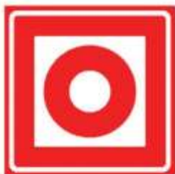
Pulsador de alarma
