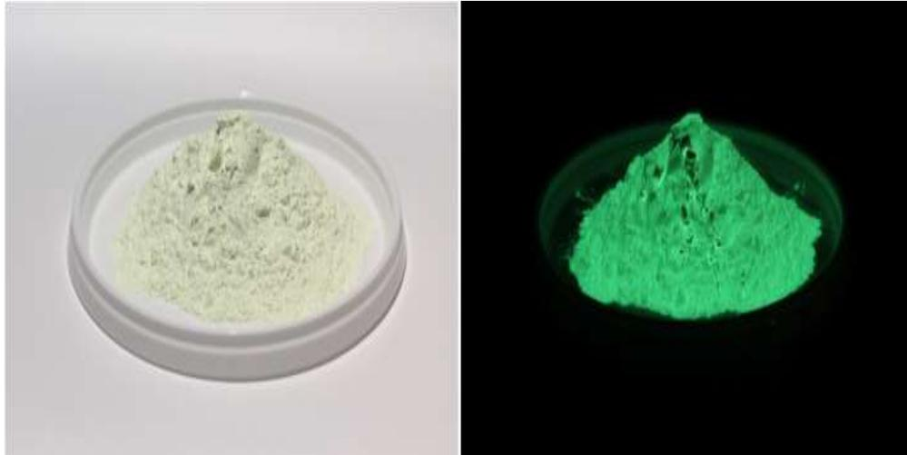
Éstos, al ser excitados por la radiación ultravioleta, almacenan la energía que, más tarde, en una situación de ausencia de luz, van liberando durante largo tiempo mediante una luz visible, hasta que los átomos regresan a su estado inicial.
