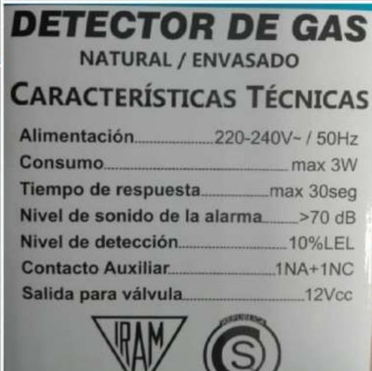
Poseen señales visibles y audibles que actúan cuando la concentración alcanza el nivel determinado (umbral de detección), disparando la alarma, para que Usted comience con el protocolo de acción frente a la señal sonora: ventilar rápidamente los ambientes, bajo ninguna circunstancia accionar llaves eléctricas, cerrar toda llave de gas presente, etc., evitando de esta manera incendios, explosiones, asfixias o problemas físicos agudos y otros tipos de accidentes no enumerados aquí.
